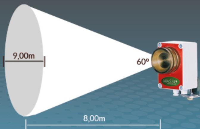
Le diffuseur génère un cône de pression acoustique ayant un angle d'ouverture de 60°.
